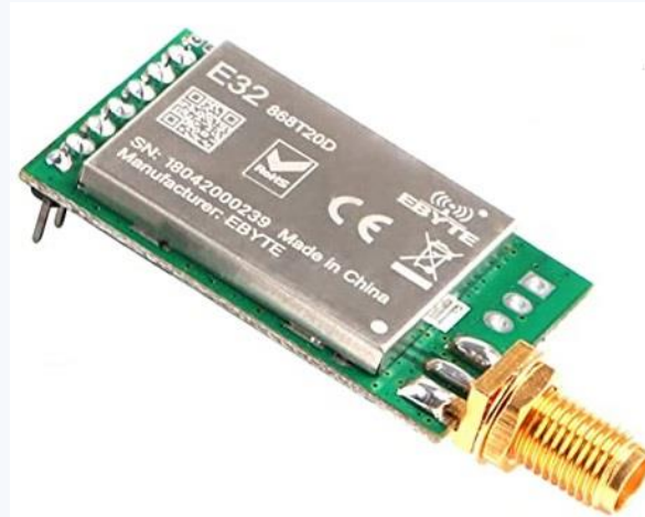
2x Lora a port sèrie CanSat i estació de terra
