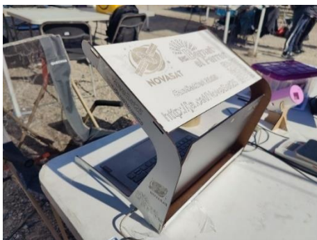
Estructura corte láser estación de Tierra protección luz Solar
